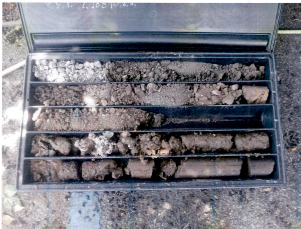
Foto 5: Sondaggio S1. Cassetta 0-5 m
