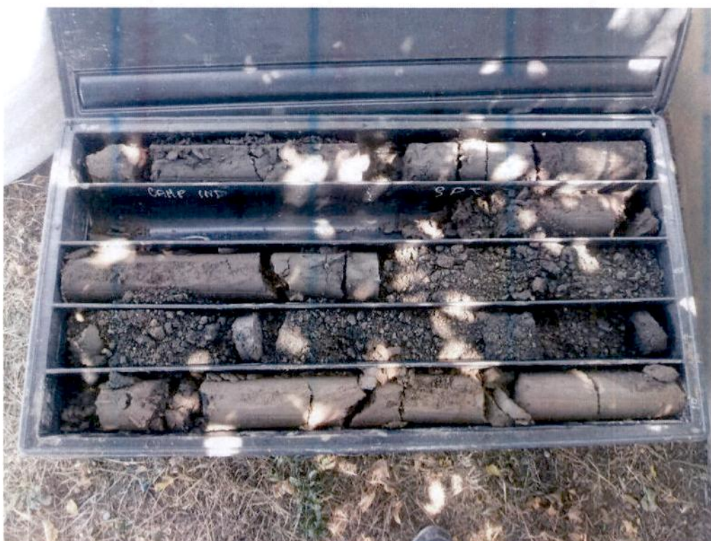
Foto 6: Sondaggio S2. Cassetta 0-5 m
